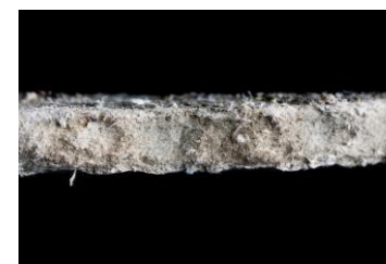
Matériau réel Ardoise Ciment
