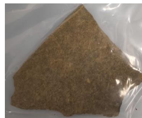
Matériau réel Ciment-Chrysotile
